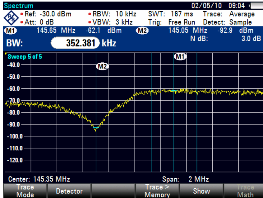
Voorbeeld TX caviteit, correct afgestemd, 30 dB reject
